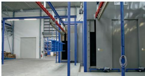
Der Haftwassertrockner (rechts) ist mit dem Einbrennofen (links im Hintergrund) kombiniert. Quelle (zwei Fotos): Redaktion
