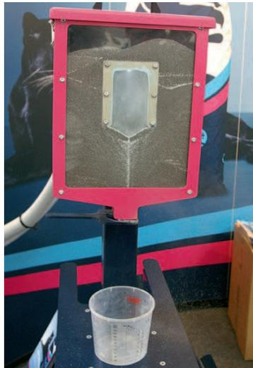
Das Modell eines Strahlbunkers: Die Beimengung des Additivs erfolgt pneumatisch über eine spezielle Dosierlanze. Quelle (drei Fotos): Redaktion
