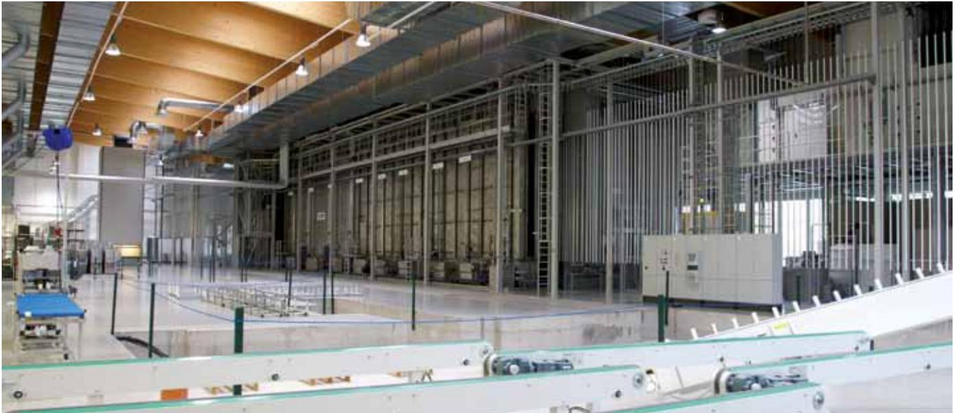
Dreh- und Angelpunkt der Anlagen- und Gebäudeplanung war die vertikale Beschichtung der 6 m langen Profile. Im Vordergrund ist der Abnahmebereich zu sehen, hinten links der Pulverpaternoster, sowie der Aufgabebereich. Rechts vom Paternoster befindet sich die Applikationskabine, davor die 9-stufige Vorbehandlung. Die Förderkette hat eine Länge von 500 m und verfügt über 2500 Aufhängepunkte.
