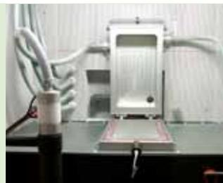
Das Pulver wird in der Farbküche kontinuierlich mit Ultraschall gesiebt.
