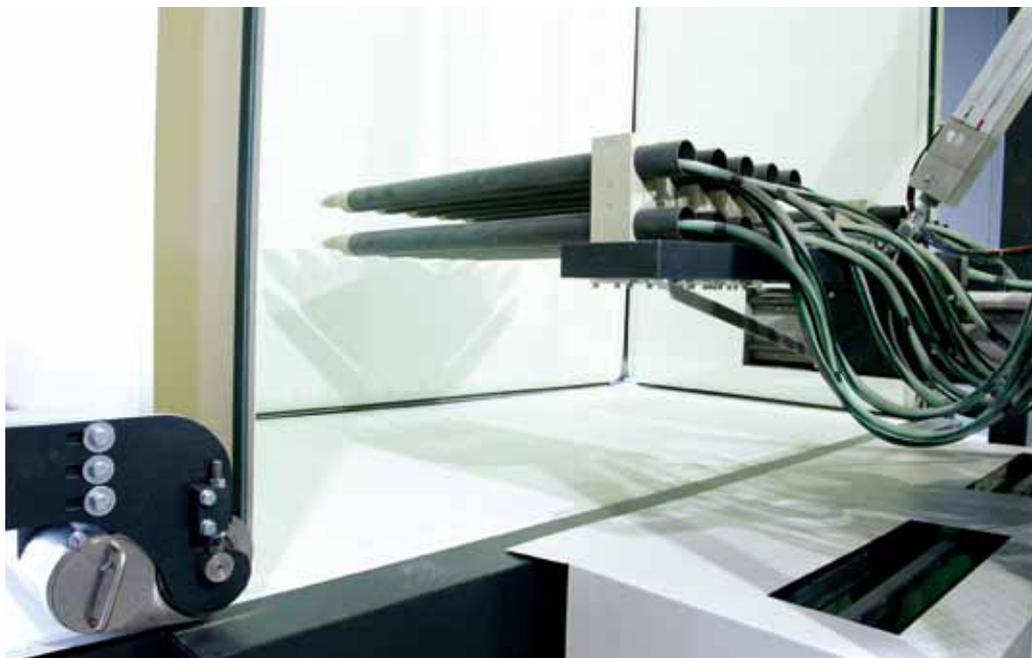
Die Beschichtungskabine besteht aus drei Vertikalbändern und einem unten laufenden Horizontalband. Bei einem Farbwechsel werden die Bänder, der Zyklon und die Pistolen im Ausblasschacht vollautomatisch gereinigt.
