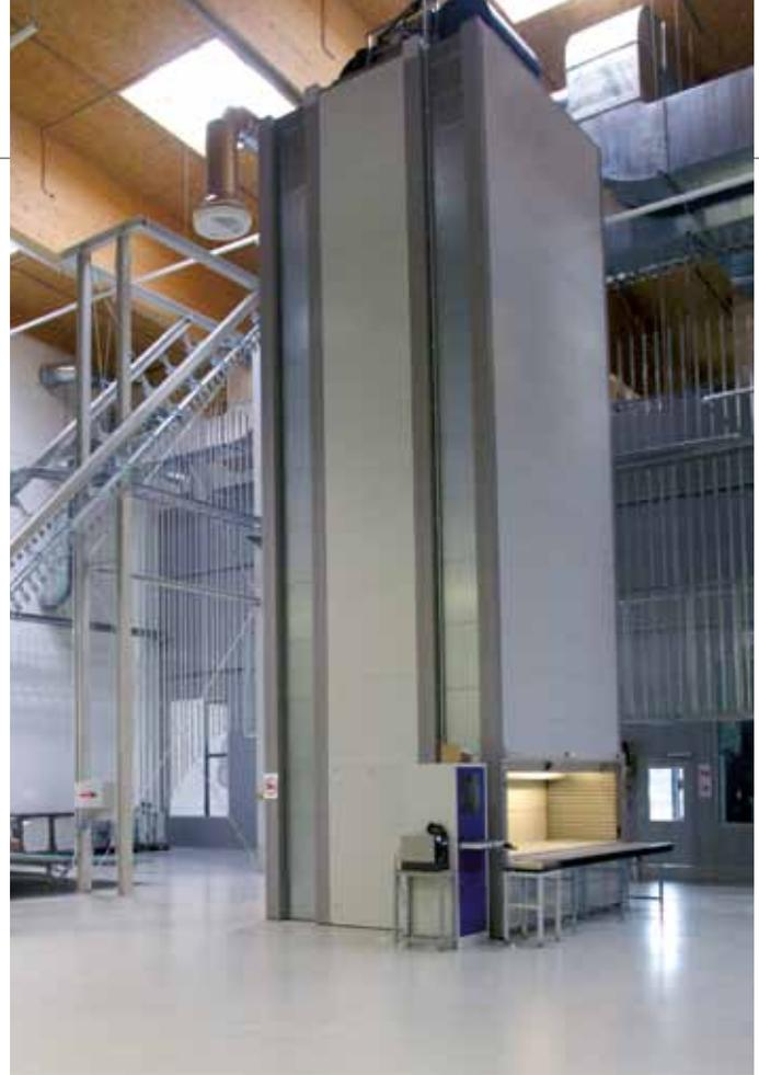
Der Pulverpaternoster steht im Bereich der Werkstückaufgabe und kann 800 20-kg-Kartons aufnehmen. Links befindet sich die Aufgabe mit dem Aufrichtförderer.
