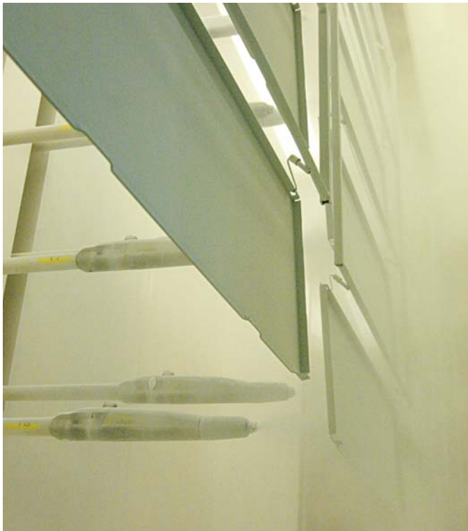
Die Pulverkabine ist mit 18 Pistolen und einer Filterabsaugung mit Druckstoßreinigung im Boden ausgestattet. Quelle: Redaktion
